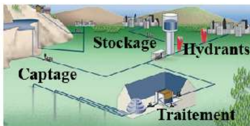
Figure 13 : Schéma de principe de la distribution d'eau potable
