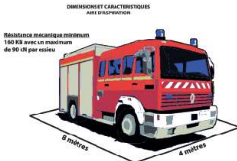
Figure 25 : Schéma de principe d'une aire d'aspiration
