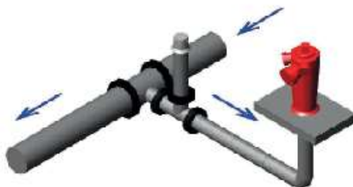
Figure 15 : Distribution de l'eau sur un PEI positionné sur un réseau ramifié
